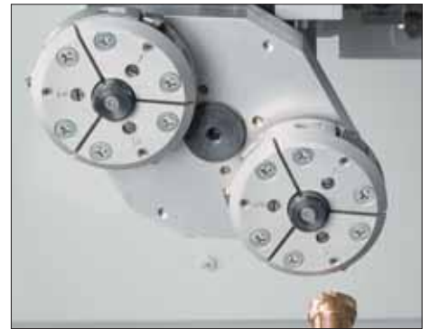
Sélectionneur automatique d'outils
