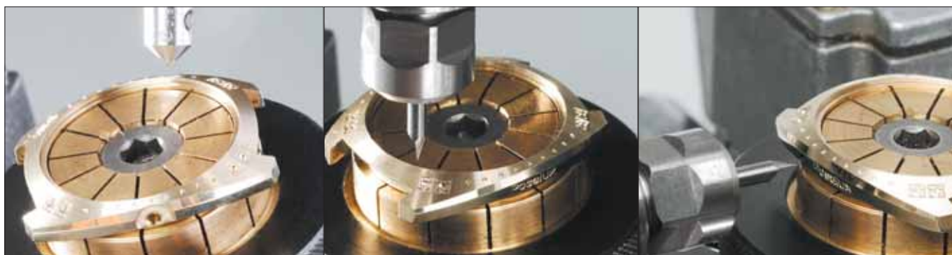
Perlage et facettage sur boîte de montre
