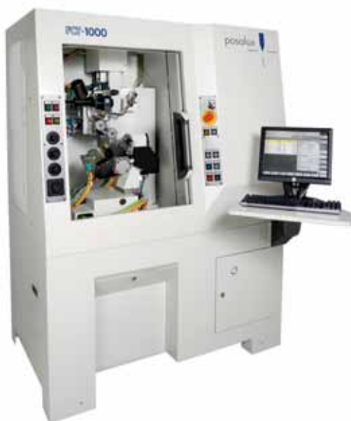
DIAMILOR FCT-1000 : 6 axes, 1 broche horizontale, 1 sélectionneur d'outils
