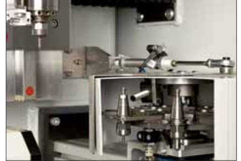
Broche haute vitesse et changeur d'outils
