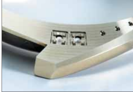
Préparation au sertissage de pierres précieuses
