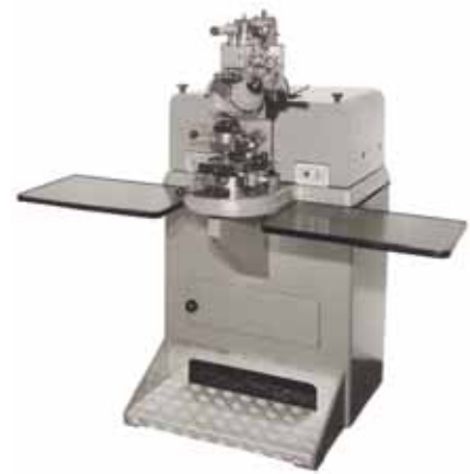
1948 : facetteuse POSALUX FCT-150-C pour l'usinage des index
