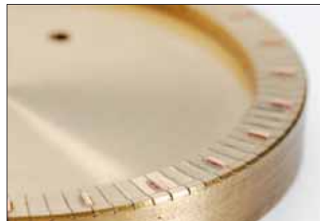
Facettage des indexes de montre sur plateau avec autocorrection optique
