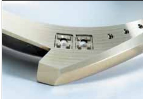
Vorbereitung für das Steinesetzen
