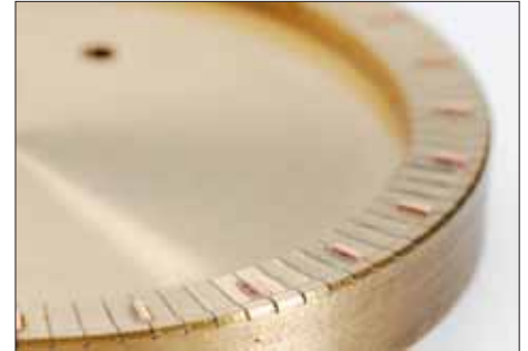
Das Facettieren auf Grundplatte mit optisch ausgerichteten Zifferblätter-Reliefzeichen
