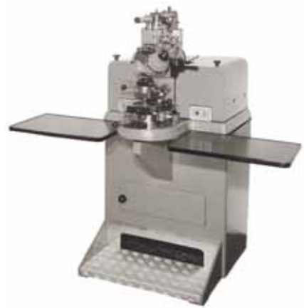
1948: POSALUX Facettier-Maschine FCT-150-C für die Bearbeitung von Zifferblätter-Reliefzeichen
